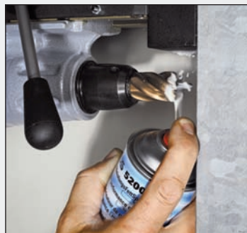
Schritt 1: Vor dem Bohrvorgang Hochleistungs-fettspray direkt in den Bohrer sprühen.
