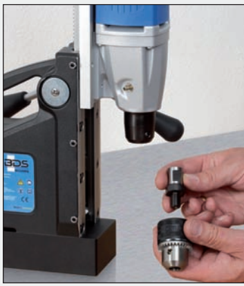
1. Adapter mit Bohrfutter verbinden.
