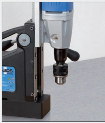
2. Bohrfutter in die Direktaufnahme einsetzen.
