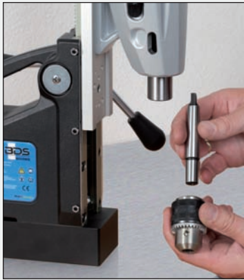
1. Kegeldorn mit Bohrfutter verbinden.
