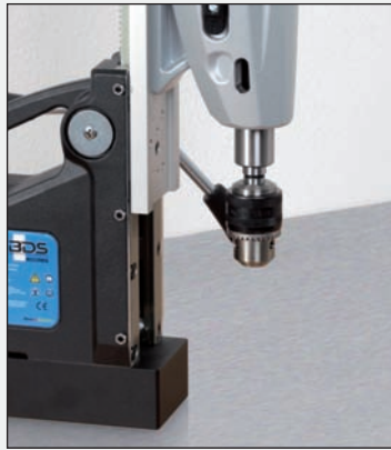
2. Bohrfutter in MK-Aufnahme einsetzen.
