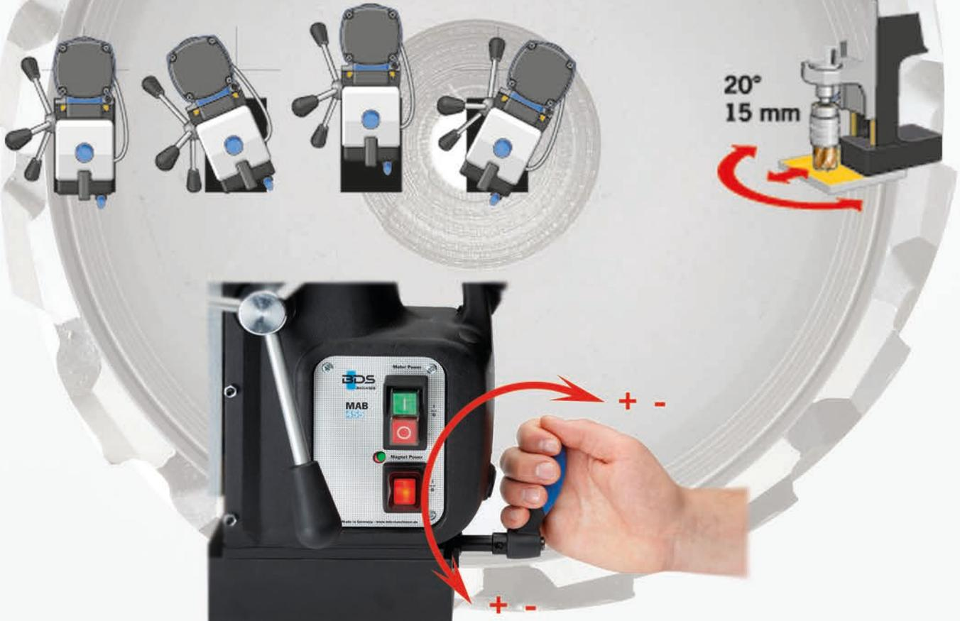
Zum Verstellen der Maschine bei aktivierter Magnetfunktion lösen Sie den Klemmhebel und bringen den Bohrer in die gewünschte Bohrposition. Nachdem die Maschine positioniert wurde betätigen Sie die Klemmung in die entgegengesetzte Richtung.
